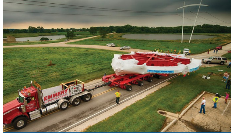
Das Team von Muon g-2 transportierte diesen Elektromagneten (Durchmesser 50 Fuß oder 15 Meter) in 35 Tagen über 3.200 Meilen über Land und Meer vom Brookhaven National Laboratory in New York zum Fermilab.
